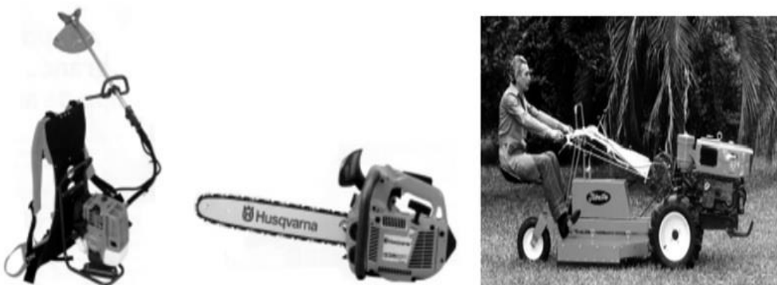
Figura 13. Roçadeira costal, motosserra e microtrator aparador de grama. Fonte: Monteiro et al. , 2001.
