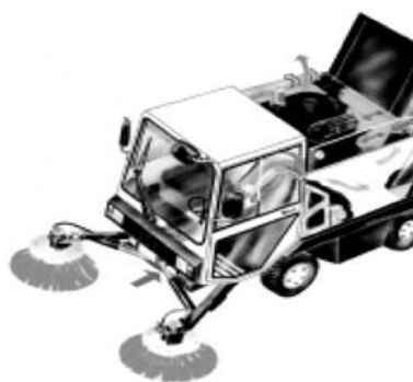
Figuras 7 e 8. Varredeira mecânica e de grande porte. Fonte: Monteiro et al. , 2001.
