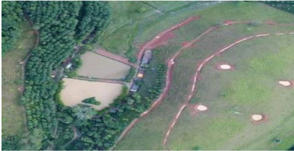
Figura 26. Aplicação da CNC em áreas com declividade acentuada como estratégia de estabilização de taludes e controle da enxurrada. Fonte: Márcio Menon, 2024.
