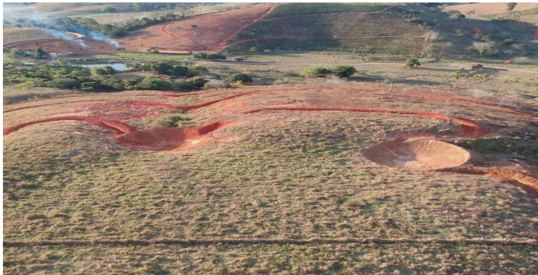
Figura 2. Barraginhas associadas a cochinchos em curva de nível: ampliam a captação de água e fortalecem a resiliência hídrica das propriedades. Fonte: Acervo Márcio Menon, 2024.
