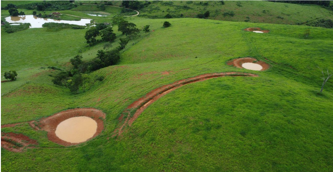
Figura 12. Curvas de nível reduzem a velocidade do escoamento e evitam sulcos erosivos, enquanto barraginhas em pontos estratégicos atuam como reservatórios temporários. Fonte: Acervo Márcio Menon, 2024.
