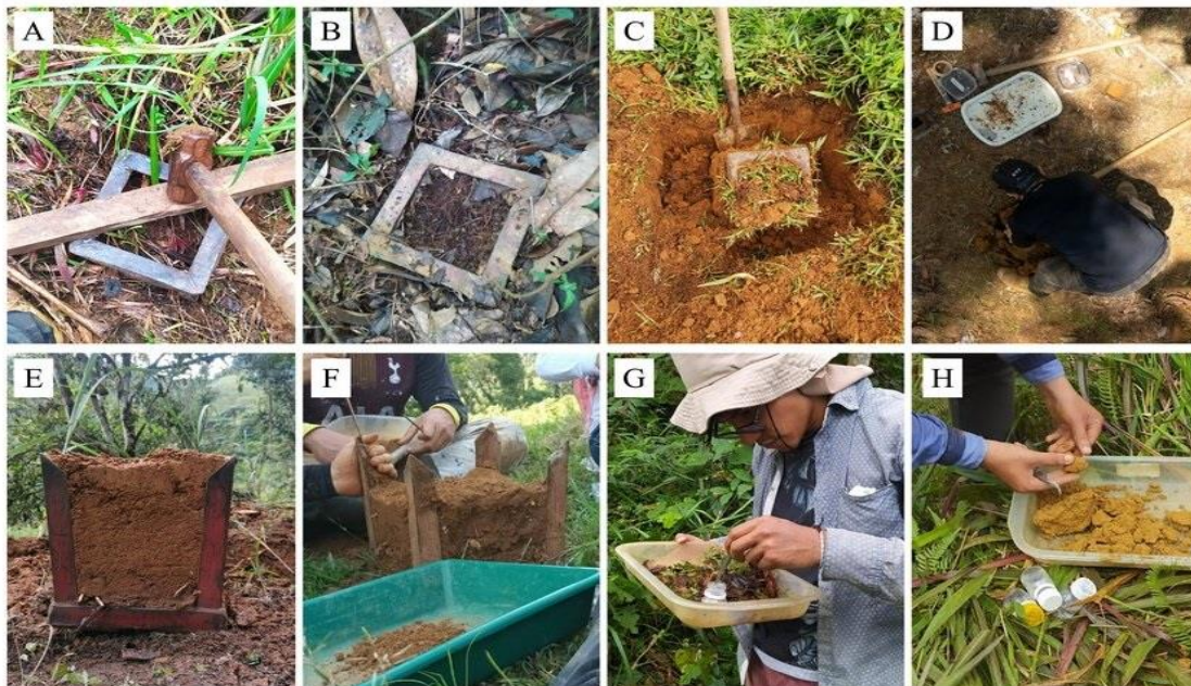
Figura 6. Metodologia TSBF. A – Introdução do monólito no solo por ação mecânica; B – Remoção da serapilheira para extração com sacos de Winkler; C – Organização da área para extração do monólito; D – Extração do monólito; E – Limpeza e organização do monólito; F – Estratificação do monólito, em que o estrato mais profundo (20–30 cm) foi removido; G – Revisão manual do estrato superficial (= A); H – Revisão manual do estrato B. Fonte: https://www.researchgate.net/journal/Biodiversity-Data-Journal-1314 .
