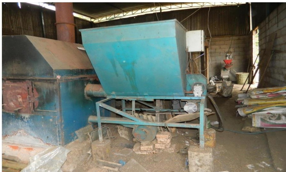
Figura 4. Queimador de palha mecânico, para secagem de café. Guaçuí – ES. Fonte: Acervo Acácio Radael de Assis.
