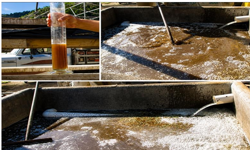
Figura 16. Tanques com água residuária resultante do processo de descascamento do café cereja. Fonte: Prezotti et al. , 2012.
