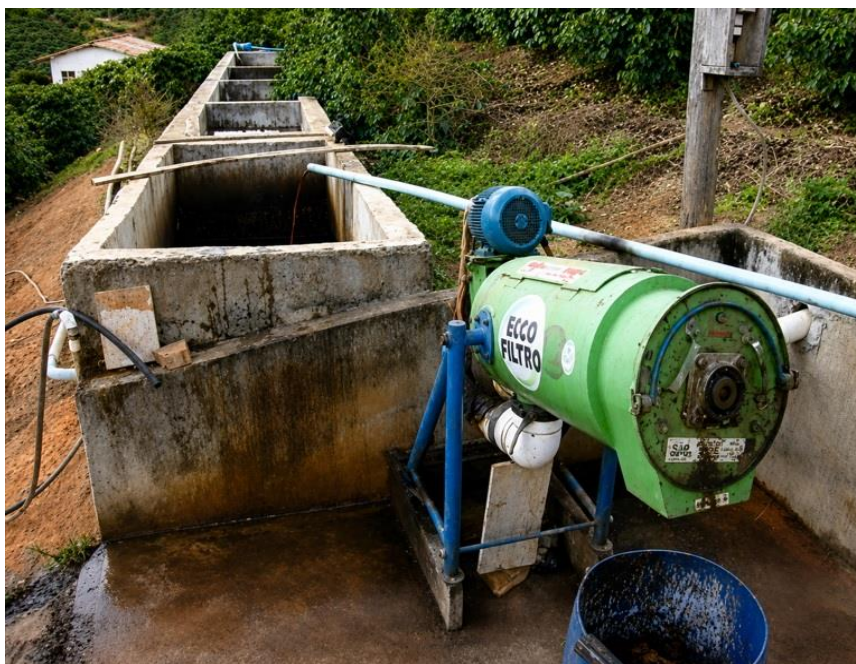
Figura 17. Utilização de tanques de decantação de resíduos e uso de filtro ecológico para retenção de partículas. Fonte: Soares et al. , 2012.
