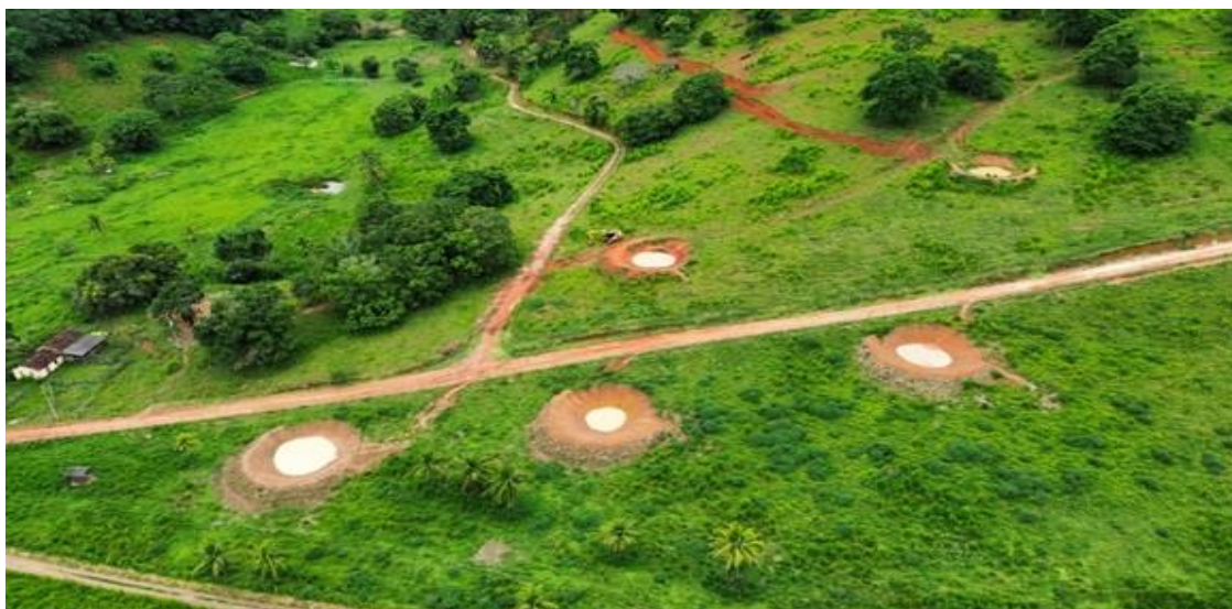
Figura 24. Tecnologias socioambientais para conservação da água: contribuição de barraginhas e cochinchos para a infiltração, retenção hídrica e recarga de aquíferos em Atílio Vivácqua, Espírito Santo. Fonte: Acervo Márcio Menon, 2025.
