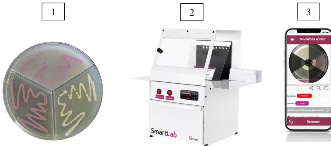
**Figura 5.** Etapas de realização da CMF utilizando as soluções da OnFarm: 1 – Semeadura/Inoculação da amostra de leite na SmartColor2; 2 – Incubação da placa SmartColor2 à 37° C por 24 horas, no SmartLab; 3 – Leitura de resultados e interpretação das cores utilizando o OnFarmApp (aplicativo utilizado pela empresa para realização da gestão dos dados).
