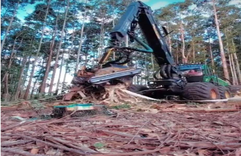
**Figura 5.** Retirada da casca do tronco do eucalipto e sua manutenção no sítio.
