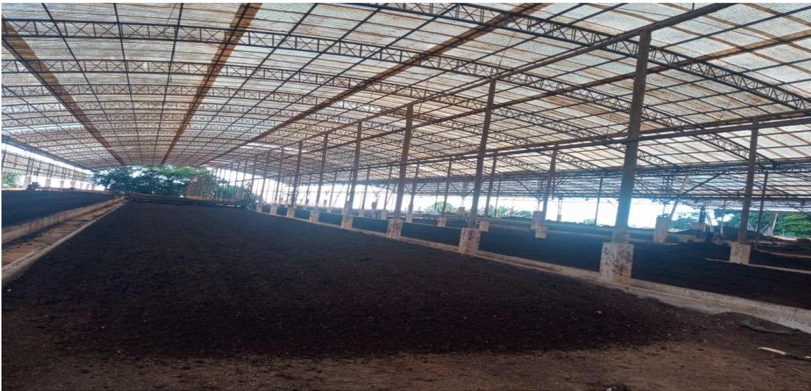
**Figura 10.** Processo de compostagem rápida com movimentação mecânica em galpão aberto. Fonte: FOLHITO, 2021.
