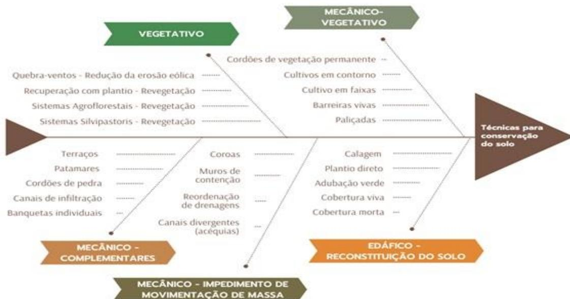
**Figura 10.** Diagrama de técnicas de conservação do solo. Fonte: Os autores, 2022.
