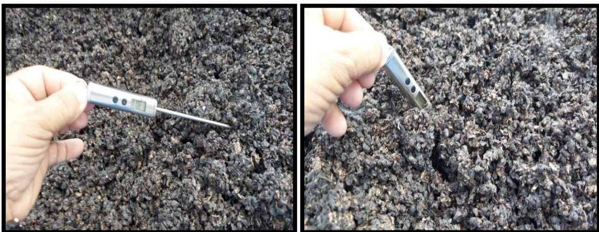
Figura 14. Termômetro digital (A), Termômetro digital introduzido no centro da composteira (B). Fonte: Páschoa, 2022.
