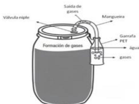
Figura 5. Esquema de produção do biofertilizante anaeróbico. Fonte: Adaptada de Medeiros e Silva Lopes (2006).
