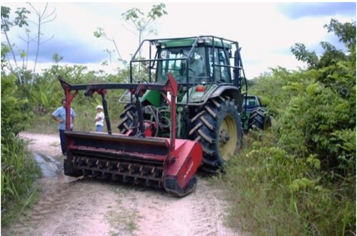
Figura 7. Modelo de tritadeira usada para preparo de área via corte – mulch: Tritucap - FM 600 da AHWI. Fonte: Sampaio; Kato; Nascimento-e-Silva (2008).
