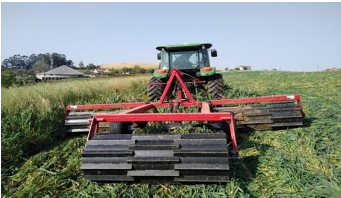
Figura 10. Rolo-faca utilizado para plantio direto. Fonte: EPAGRI (2020).
