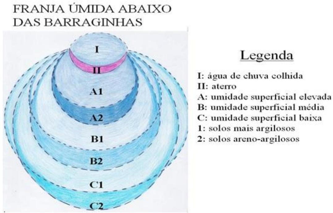
**Figura 19.** Demonstração das franjas úmidas formadas abaixo das barraginhas. Fonte: EMBRAPA (2016).
