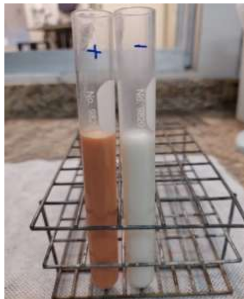
Figura 28. Resultado da análise de peróxido de hidrogênio positivo e negativo.
