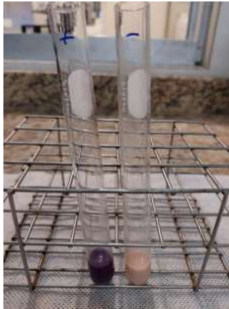
Figura 30. Resultado da análise de hidróxido de sódio positivo e negativo respectivamente.
