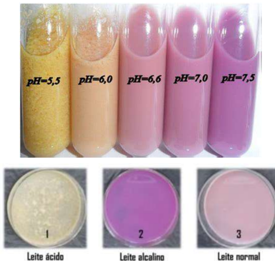
Figura 8. Demonstração de leite ácido (pH 5,5 e 5,6) com formação de coágulos, na coloração amarela, leite com pH normal (6,6 e 7,0) e estável ao
