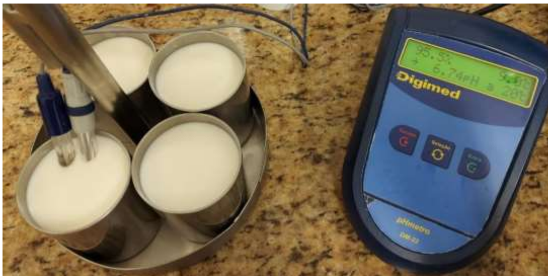
Figura 6. Determinação do valor de pH de amostras de leite cru dos tanques de veículo transportador.
