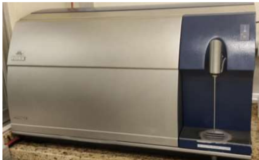
Figura 5. Equipamento MilkoScan FT2 para teste de avaliação físico-química e ureia no leite.
