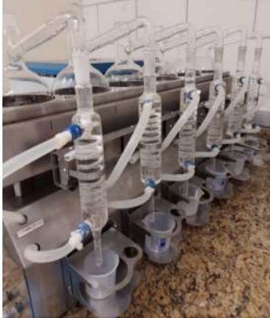
Figura 25. Destilador de formaldeído utilizado na análise para detecção de formol.
