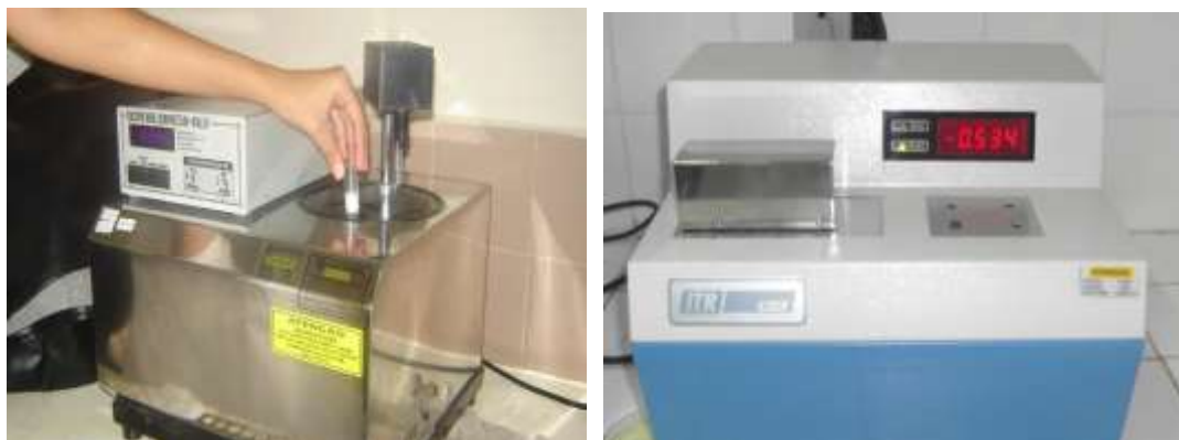
Figura 15. A -crioscópio. B – tubo de crioscopia para leiteira pelo equipamento.
