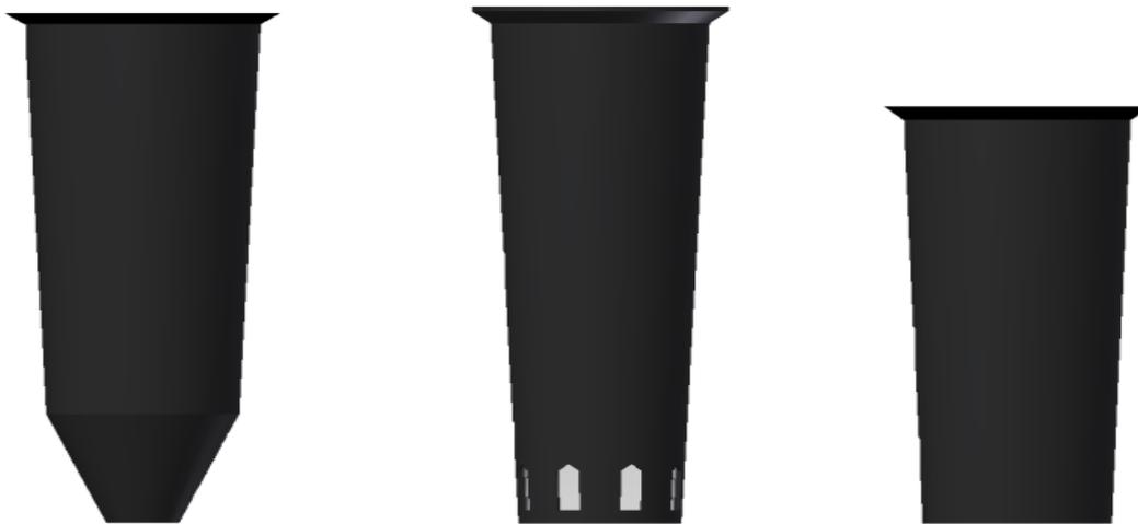
**Figura 15.** Principais tipos de tubetes empregados na produção comercial de mudas clonais de *C. canephora*. Cônico tradicional (A); Cônico com fundo chato e aberturas laterais (B); e Cônico com fundo invertido (C). Fonte: Andrade et al. (2016). Foto: Marcelo Curitiba Espíndula (2016).
