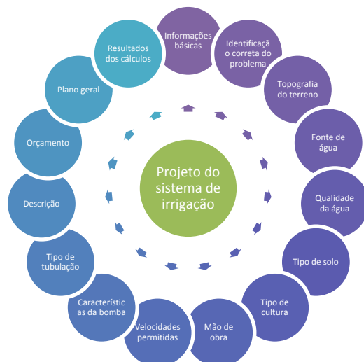
Figura 1. Esquema das etapas do projeto de um sistema de irrigação.
