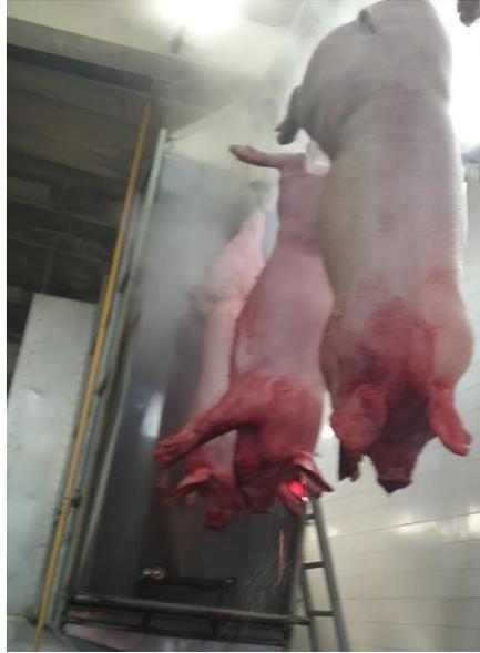
**Figura 16.** Suínos entrando no túnel de escaldagem.
