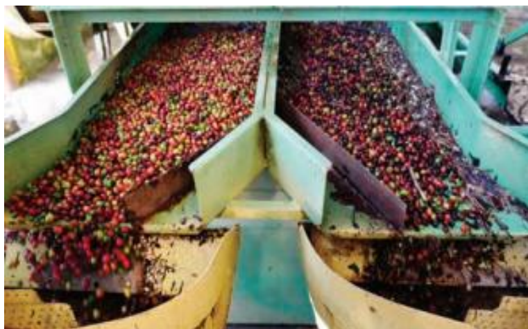
Figura 4. Separação do fruto de café por via úmida. Fonte: “Café: Classificação e Degustação”, SENAR, 2017.
